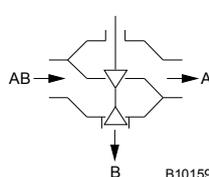
Значение  $k_{VS}$  в обводном канале примерно на 30% меньше чем в регулирующем проходе. Таким образом, сопротивление потока нагрузке берется в расчет, так что общий протекающий поток при любом положении штока остается практически постоянным.
